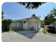
Entrando nell'area si riscontra la presenza di una pavimentazione in ghiaia, a tratti inerbita, di difficile percorribilità per i disabili. Si propone la creazione di un percorso pavimentato in terra stabilizzata drenante, che colleghi la rampa esistente, di accesso al bar, al bagno disabili esistente, utilizzato dal pubblico.
