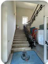
Si rileva che la scala interna, pur essendo dotata di servoscala, non presenta il corrimano a parete. I gradini inoltre risultano privi di segnaletica cromatica per ipovedenti e di antiscivolo.
