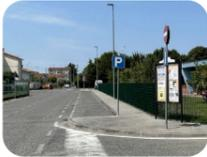
Nell'ottica che tale parcheggio possa essere utilizzato dagli ospiti della Scuola Primaria di Primo Grado, si rileva la mancanza di una rampa di raccordo tra la quota del marciapiede e quella dell'eventuale parcheggio disabili (si veda punto 4.1). Si prevede anche l'inserimento di loges.
